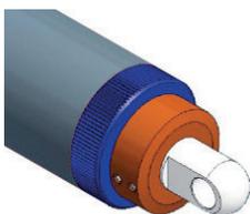
**Verstellsicherung für die Ausführung des DIREKT mit Augen:** Wird über das Auge geschoben und dann mit 2 Madenschrauben gesichert. Der Druck auf das Rändelrad verhindert ein unbefugtes Verdrehen der Regulierung.
