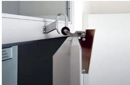
Türdämpfer werden in der Regel mittig am oberen Rand der Tür installiert. Der Haken sitzt darüber auf dem Türrahmen. Beim Öffnen der Tür drückt der Haken automatisch den Rollenhebel nach unten und spannt dadurch die integrierte Feder.
