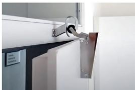
Wird die Tür zugeworfen, schwenkt der Rollenhebel bei Erreichen des Hakens nach oben und dämpft dabei die Türbewegung hydraulisch ab. Die Dämpfung ist progressiv, d.h., dass die Türen unabhängig von Größe und Gewicht zuverlässig und sanft abgefangen werden – selbst wenn sie schnell zugeworfen wurden.
