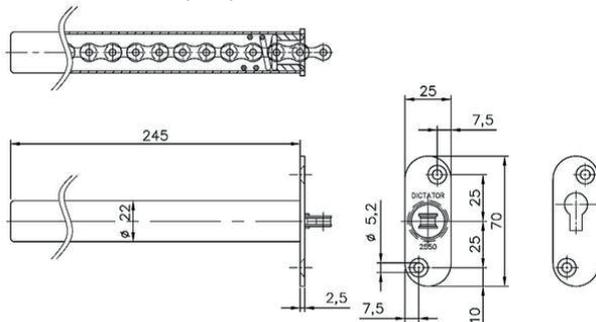
E 22/2550 mit eckiger Frontplatte / with angular front plate /
