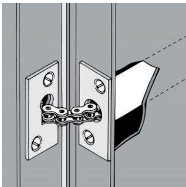
Faire un perçage dans le front de la porte pour le tube de l'Adjunkt encastré (diamètre 23 mm). Ensuite insérer l'Adjunkt encastré dans ce perçage et fixer la plaque frontale avec deux vis noyées.
